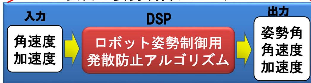
水晶ヨーレートセンサより DSP : Digital Signal Processor ロボット制御へ
