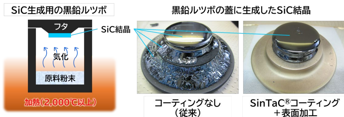
図 1 左:ルツボによる SiC 結晶生成の概要。
