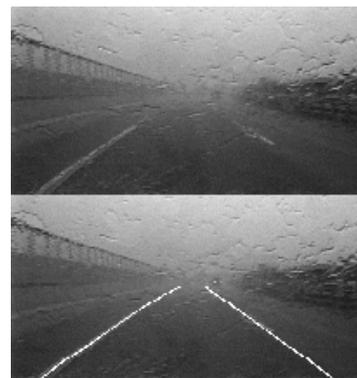
図4 レーンマークの検出結果例
