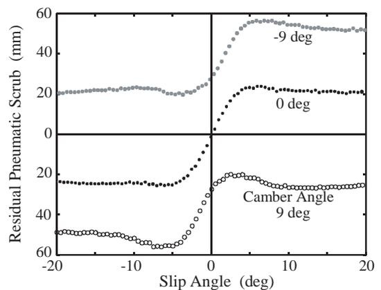
(b) Tire size : 265/70R16, Vertical load : 9.8 kN
